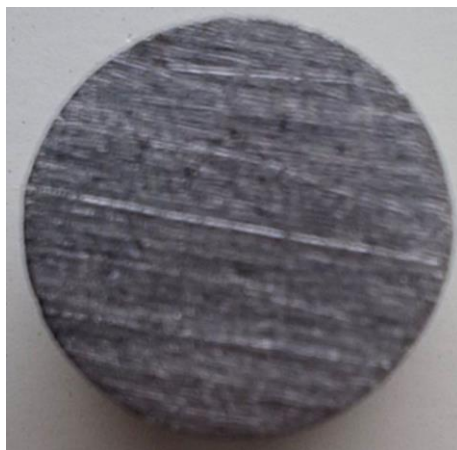
Рисунок 2.1 – Загальний вигляд поверхні вихідного зразка сталі Ст3
