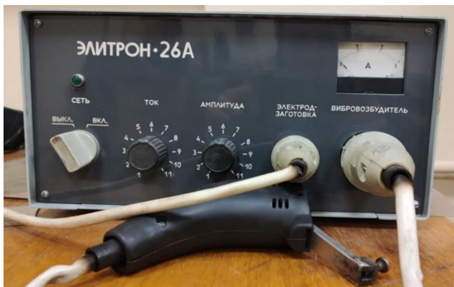
Рисунок 2.2 — Загальний вигляд установки “ЕЛІТРОН– 26А”
