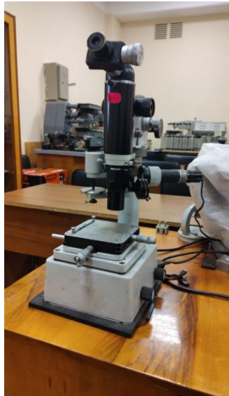
Рисунок 2.5 – Вигляд ззовні приладу ПМТ-3
