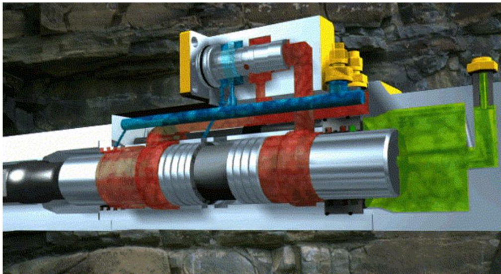
Рис.1.11 Принцип роботи гідромолоту [23]
