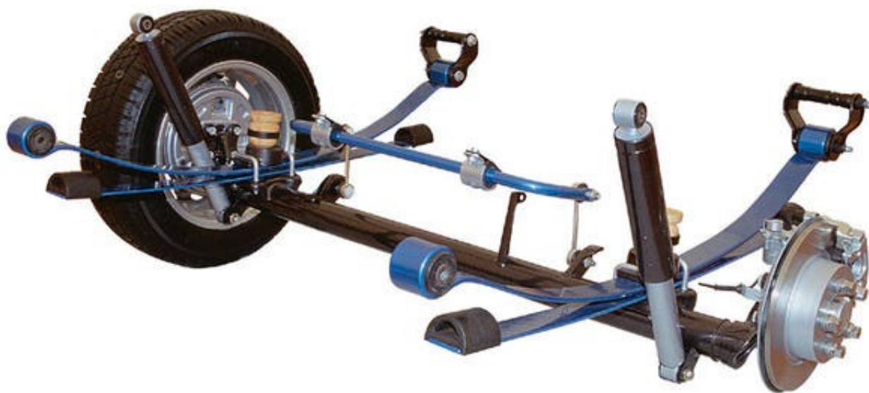
Рисунок 1.7 — Загальний вигляд торсіонної підвіски [6]
