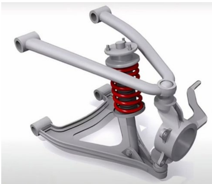
Рисунок 1.8 – Типова конструкція двоважільної підвіски [4]
