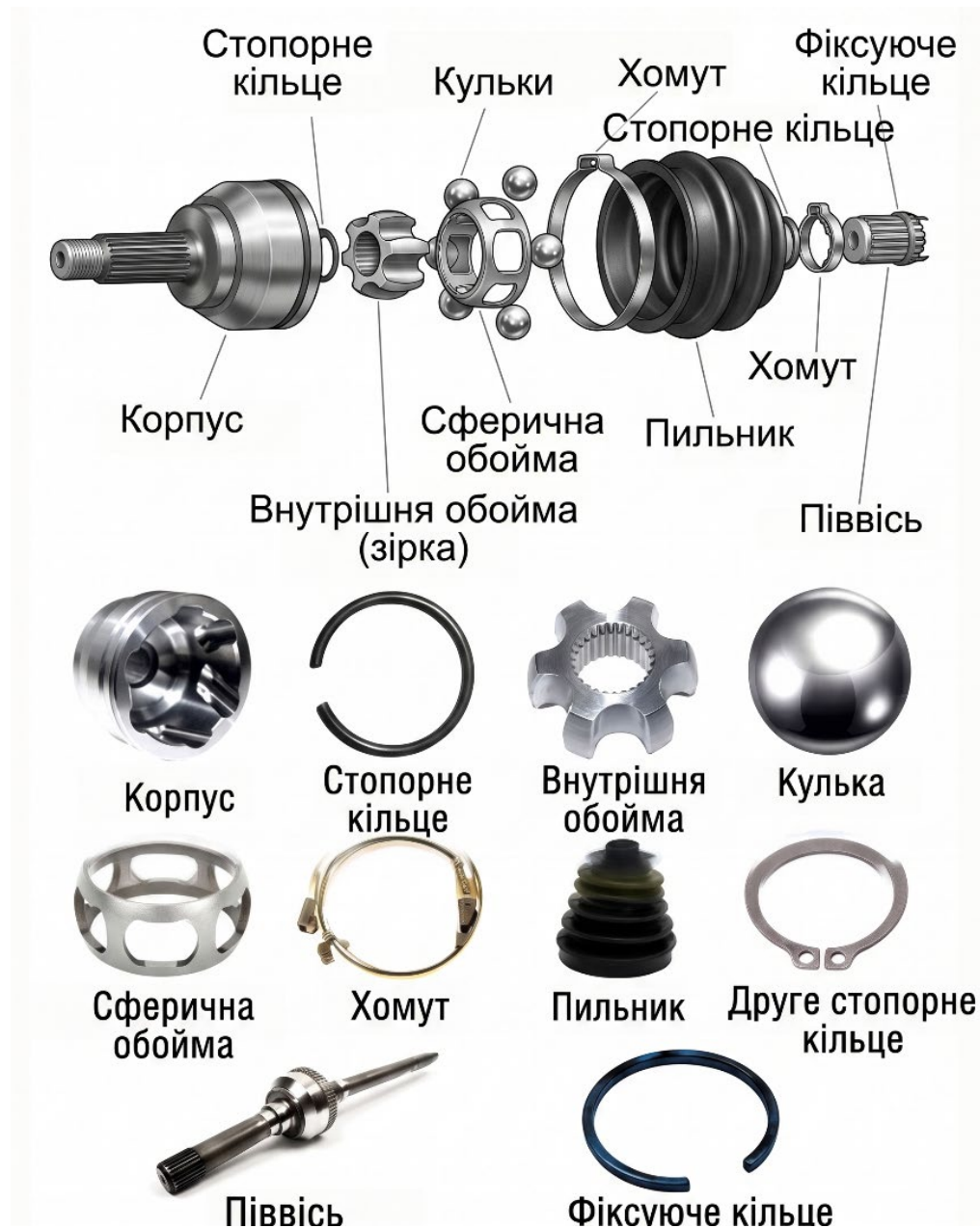
Рисунок 1.10 Конструкція ШРКШ [8]
