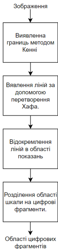
Рисунок 5.1 – Схема методу розпізнавання області показань лічильника
