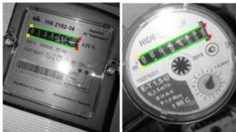
Рисунок 5.3 – Приклад виявлення області показників лічильника [38]
