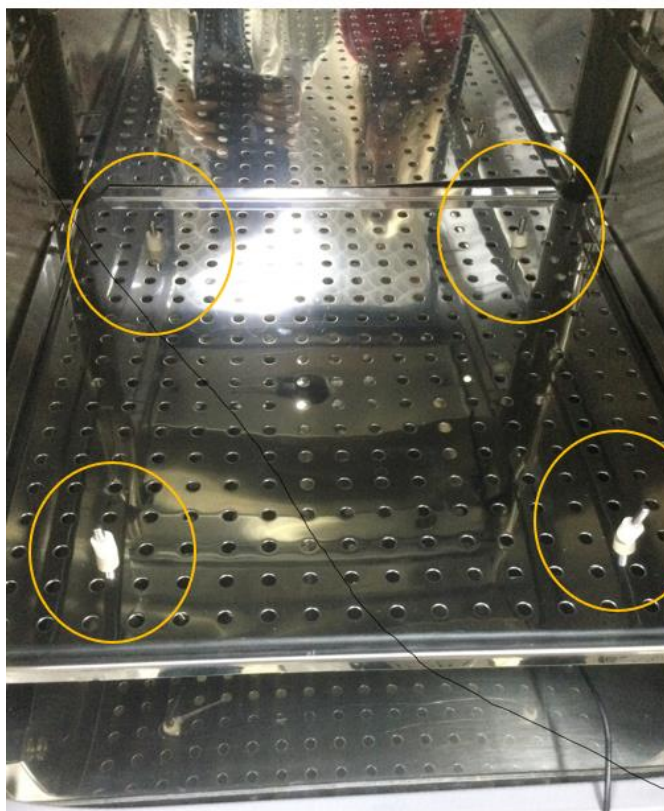
Рис. 7. Фіксація температурних датчиків за допомогою хлоропренових кілець ( жовтими колами позначено місце знаходження).
