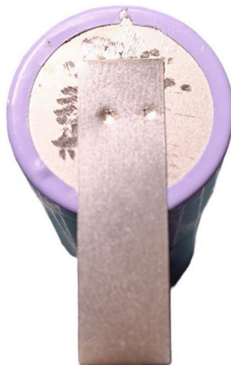
Рисунок 3.6 —Зварювання пластини з нікелю до мінусового контакту елемента при проміжку часу відкритих ключів у 40%
