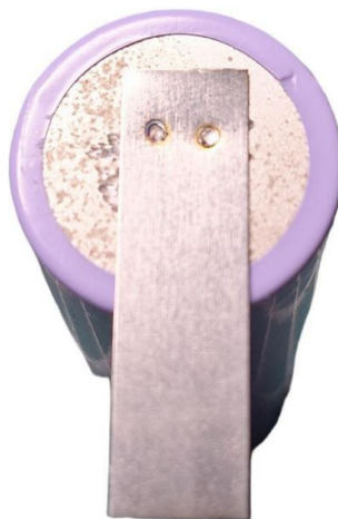
Рисунок Б.2 – Зварювання пластини з нікелю до мінусового контакту елемента при проміжку часу відкритих ключів у 80%
