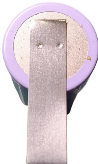
Рисунок 3.5 – Зварювання пластини з нікелю до мінусового контакту елемента при проміжку часу відкритих ключів у 20%
