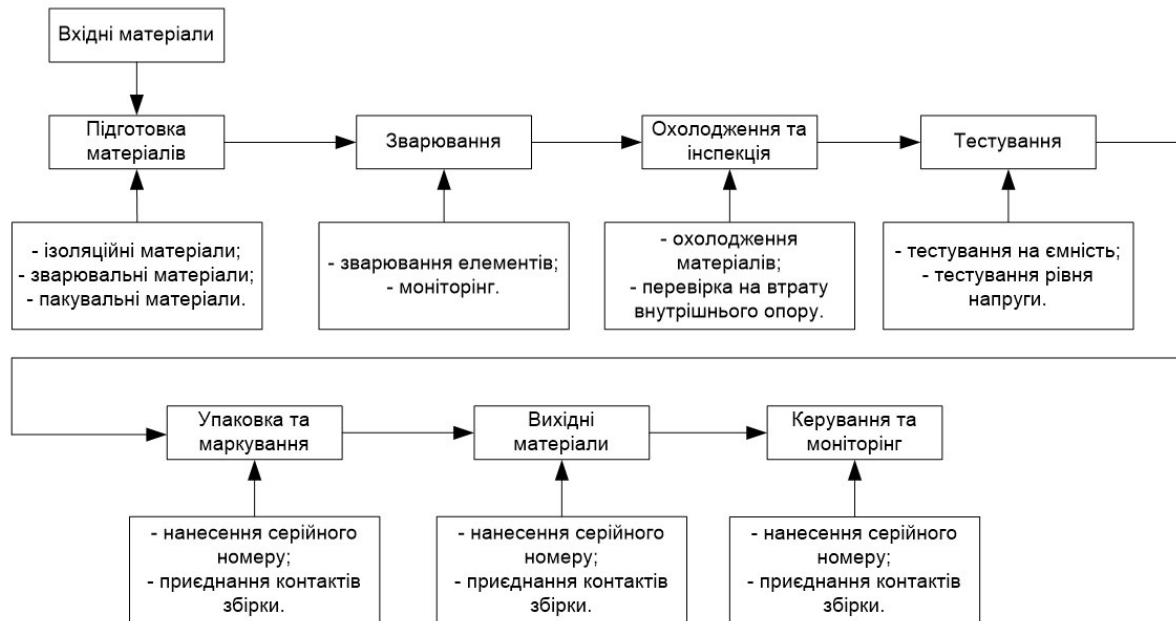
Рисунок 1.1 – Блок-схема функціональних зв'язків ЕТК зварювання акумуляторних збірок
