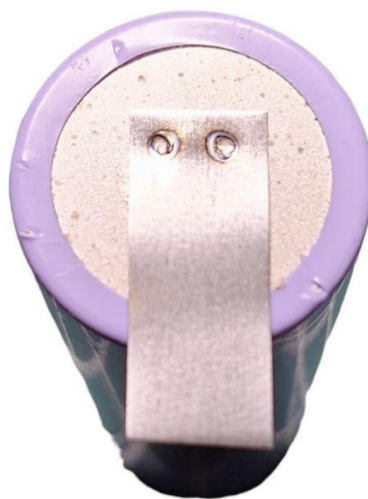
Рисунок Б.4 – Зварювання пластини з нікелю до мінусового контакту елемента при проміжку часу відкритих ключів у 120%
