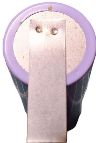
Рисунок Б.3 – Зварювання пластини з нікелю до мінусового контакту елемента при проміжку часу відкритих ключів у 100%
