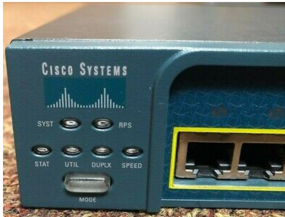
Рис. В.1. Кнопка для скидання налаштувань на передній панелі Cisco.
