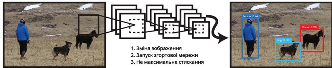
Рисунок 2.5 – Система виявлення YOLO. Система YOLO (1) змінює розмір вхідного зображення до 448 \times 448 , (2) запускає одну згорткову мережу на зображенні і (3) встановлює поріг виявлення відповідно до довіри моделі (адаптовано з [7])
