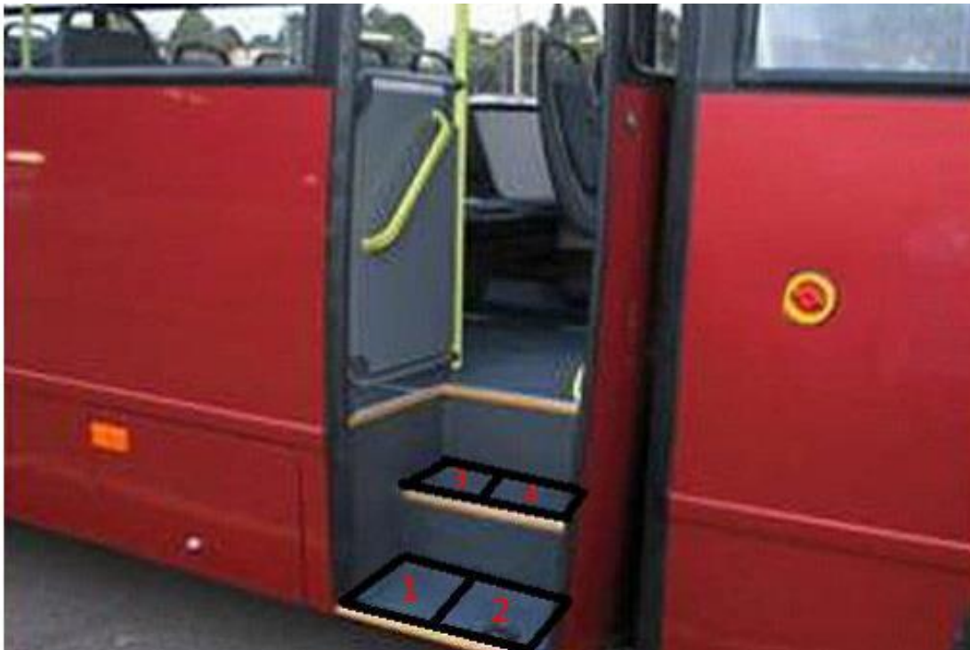
Рисунок 3.1 – Приклад монтування датчиків на сходах
