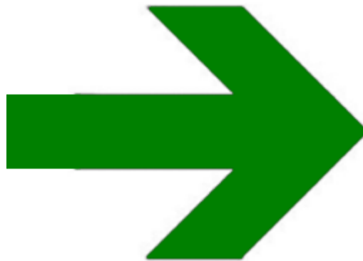
Рисунок 2.2 — Стрілка, яка вказує напрямок руху людей (ISO 3864-3, стрілка типу D)[1]
