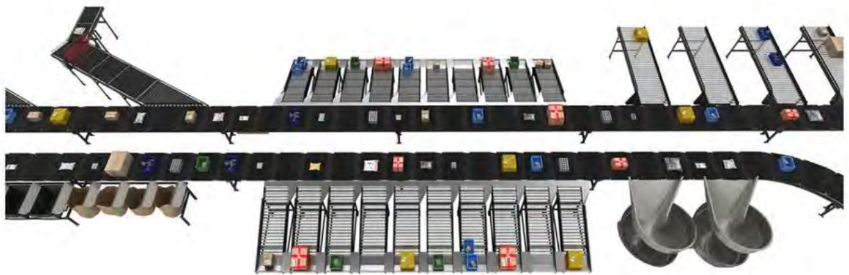
Рисунок 1.3 Принцип дії високошвидкісного сортувального конвеєра типу Crossbelt
