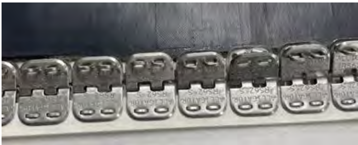
Рисунок 1.6 Механічне роз'ємне з'єднання кінців конвеєрної стрічки шарнірного типу
