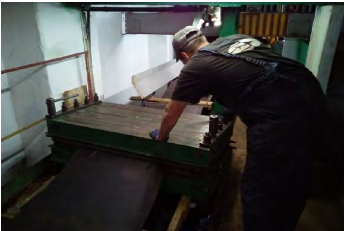
Рисунок 1.4 Процес підготовки та стикування стрічки методом гарячої вулканізації
