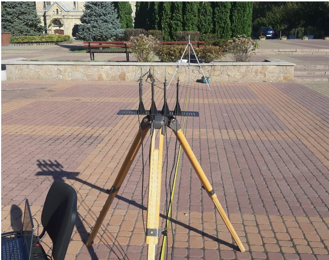
Рис. 4.6. Антенна решітка, яка розташована під кутом рівним 0^\circ відносно передавальної антени в ході експерименту.
