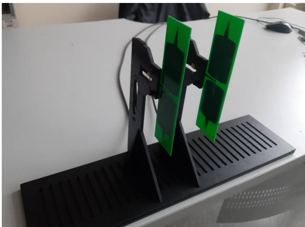
Рис. 4.1. Фото двоелементної антенної решітки пеленгаційної системи
