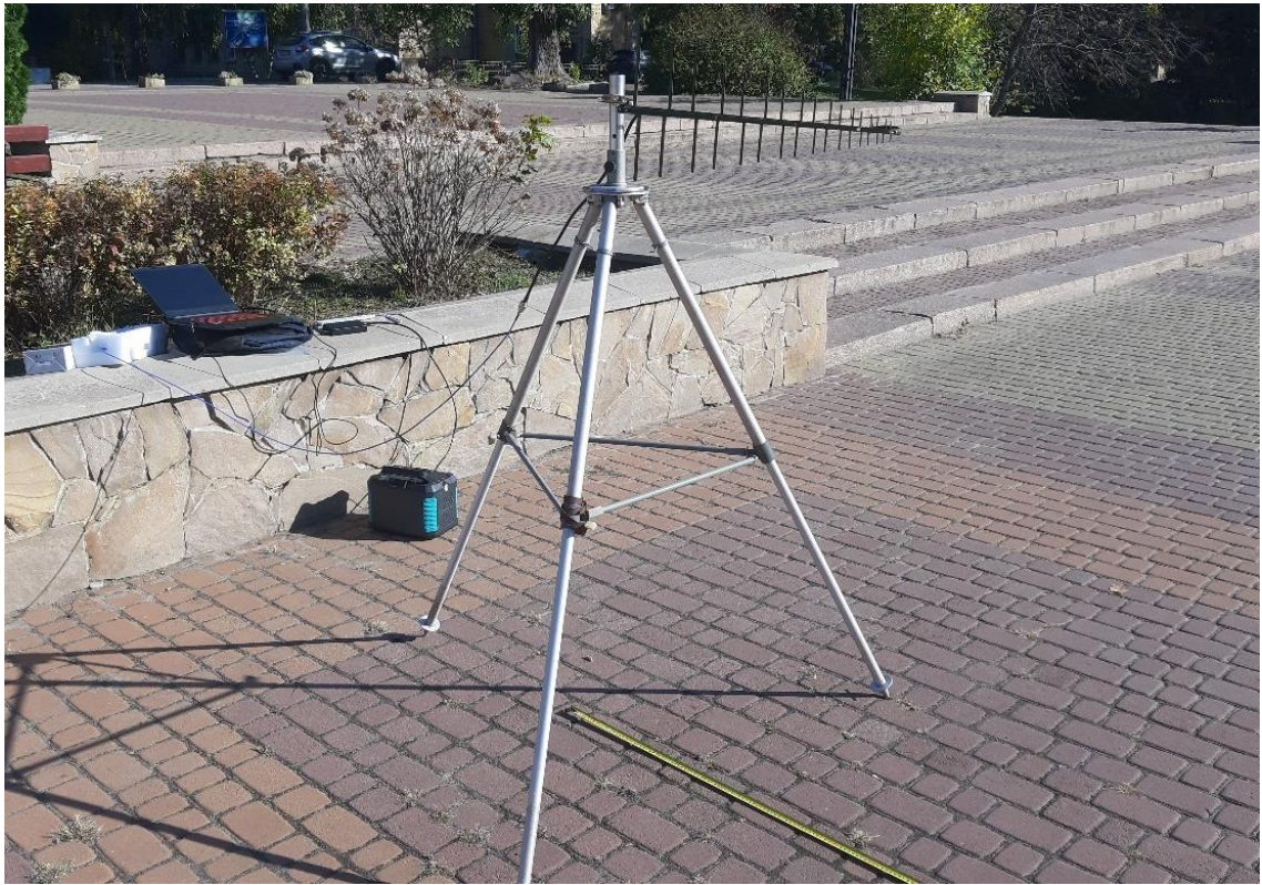
Рис. 4.7. Логоперіодична антена на штативі з градусною шкалою.
