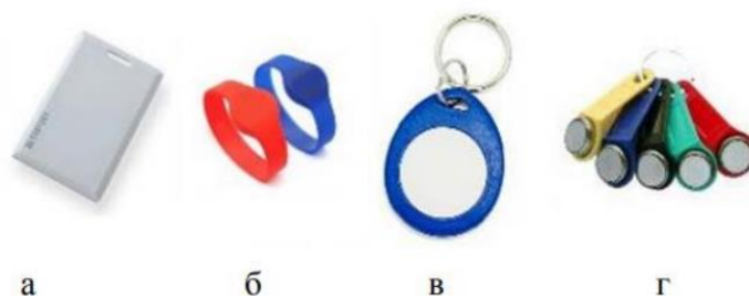
Рисунок 2.2 – Види ідентифікаторів: а – пластикова карта; б – браслет; в, г – брелоки Touch Memory
