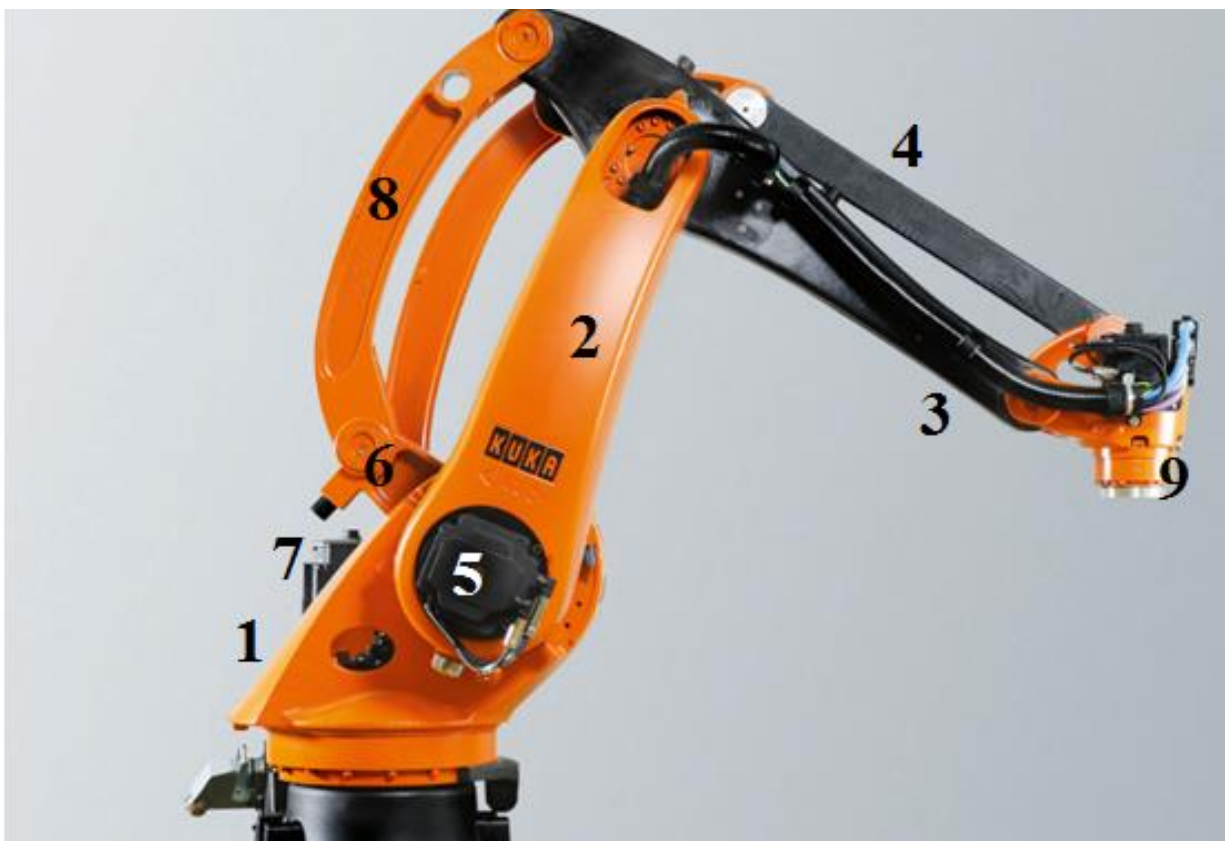
Рис. 11 – будова маніпулятора з ангулярною системою координат;
