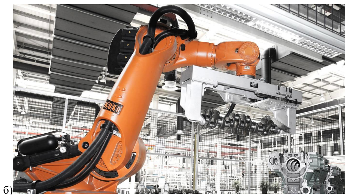
Рис. 6 – зовнішній вигляд маніпулятора KR 1000 1300 titan PA: а) маніпулятор, обладнаний захватом для пакетування; б) маніпулятор, обладнаний захватом для валів;
