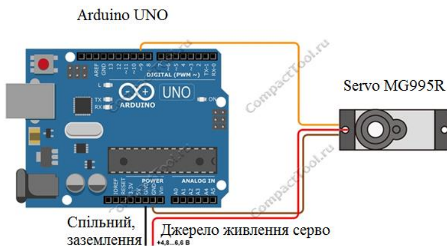
Рис. 32 – схема рекомендованого під'єднання сервопривода до Ардуіно;
