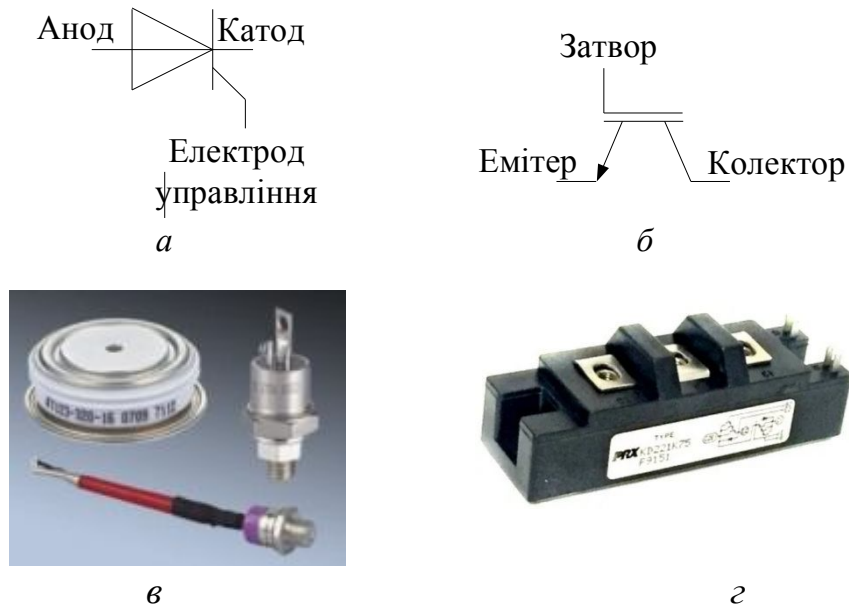
Рис. 1.4. Напівпровідникові елементи: а, в – тиристор; б, г – транзистор IGBT
