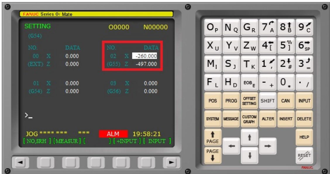
Рисунок 3.21 – Задання системи координат заготовки
