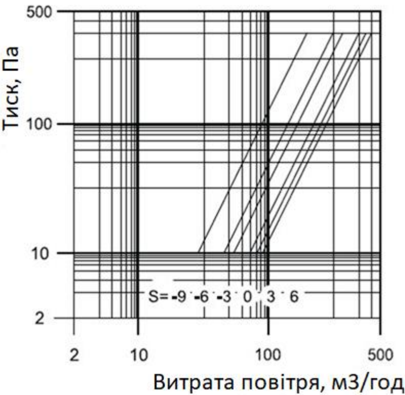
Рис. 5.8 Діаграма залежності втрати тиску від витрати повітря
