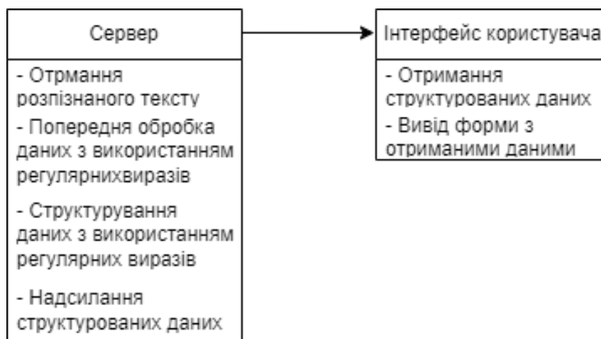
Рисунок 3.8 – Схема модуля обробки та структурування даних
