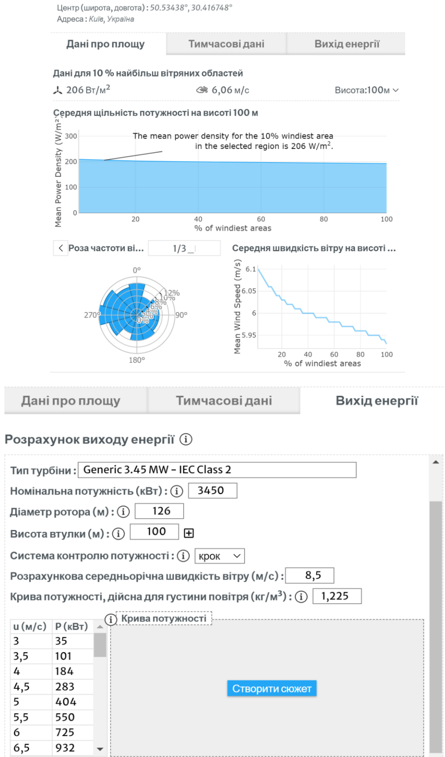
Рисунок 2.2 – Розрахунок потужності для вітрової установки, згідно географічного розташування та параметрів вітру
