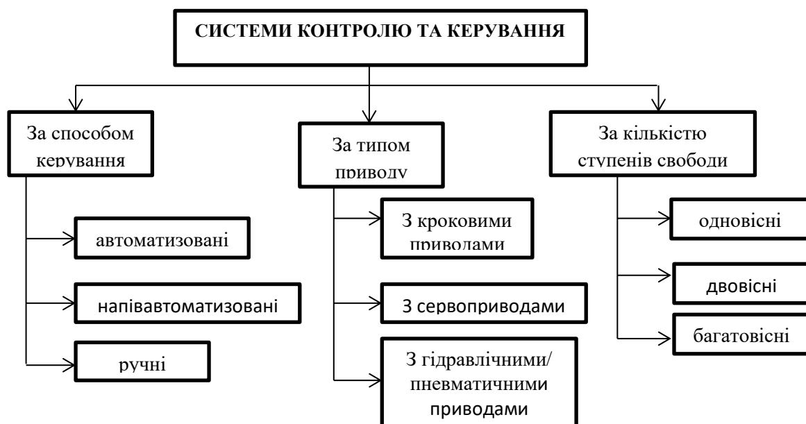
Рис. 1.5.2 – Класифікація систем контролю та керування верстатами з ЧПК
