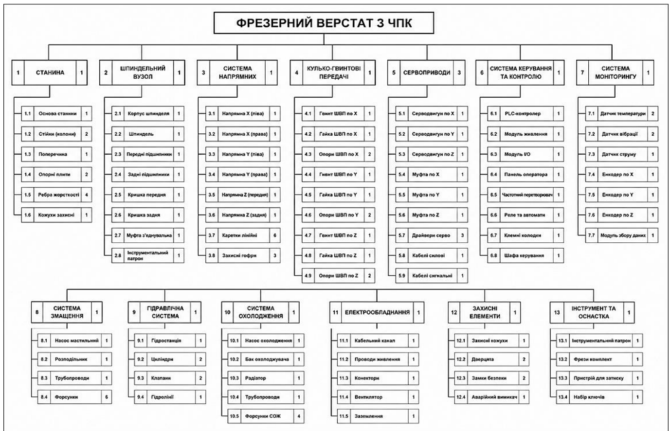
Рис. 2.1.4.1 – Технологічна схема складання фрезерного верстата з ЧПК
