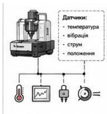
Рис. 1.4.1– Апаратна (вбудована) система контролю та моніторингу ЧПК-обладнання[4]
