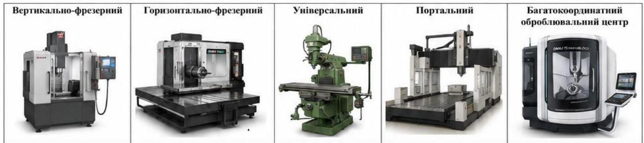
Рис. 1.1.2– Класифікація фрезерних верстатів з ЧПК
