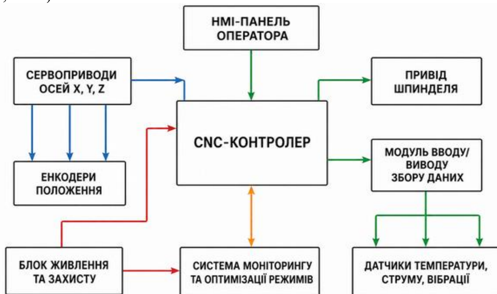
Рис. 2.1.1.1 – Структурна схема системи автоматизованого керування
