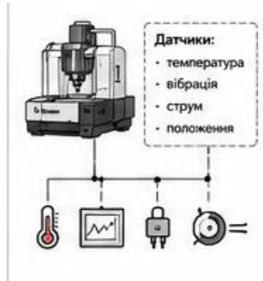
Рис. 1.4.2– SCADA-система контролю та моніторингу виробничих процесів[2]
