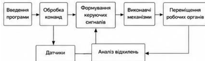
Рис. 1.2.3 – Алгоритм роботи системи автоматизованого керування
