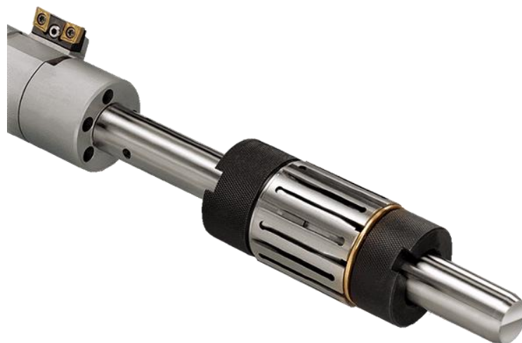
Рисунок 1.19 – Модифікація модульної розточувальної головки Gogsdill для обробки сідла вентиля [6]
