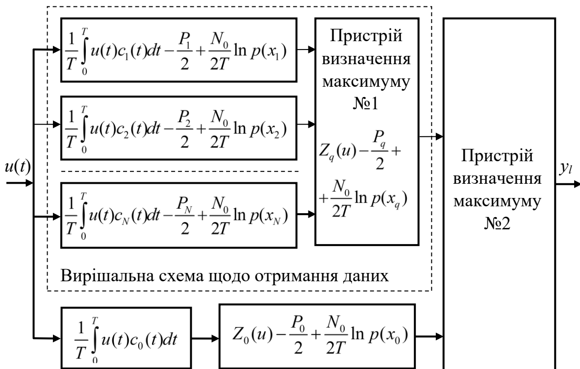
Рис. 3.4.5. Вирішальна схема оптимального прийому дискретної інформації з метою виявлення ознак небезпечного сигналу та з виділенням схеми щодо отримання інформаційних даних
