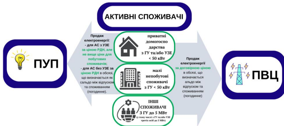
Рисунок 1.2 — Схема взаємодії активного споживача із зовнішньою електромережею[3]
