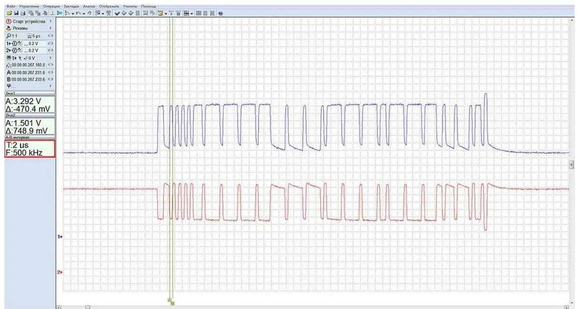
Рис 1.6 Осциллограмма цифрового сигнала авто по CAN лінії
