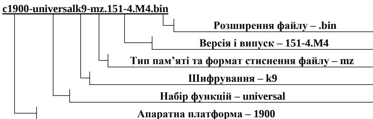
Рисунок 2.18 – Прийняті корпорацією Cisco позначення імені файлу образу IOS
