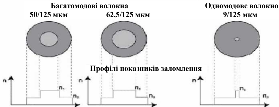
Рисунок 1.43. Одномодове та багатомодові волокна у перерізі
