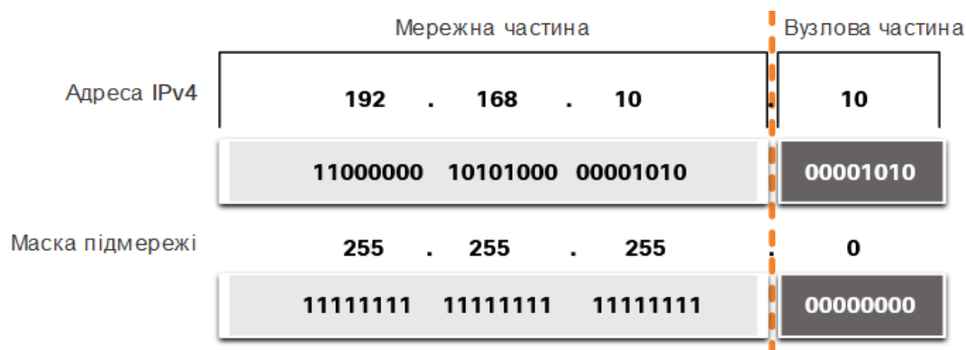
Рисунок 1.54 – Використання маски підмережі
