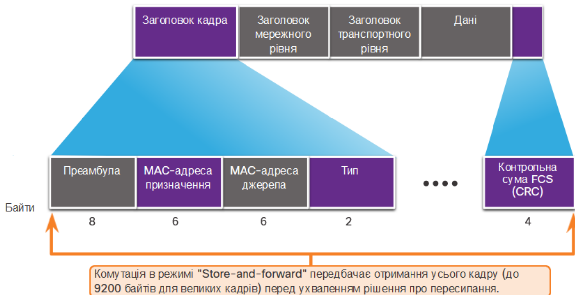
Рисунок 1.29 – Комутація з проміжним збереженням
