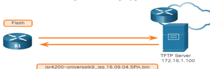
Рисунок 2.11 – Зберігання файлів конфігурації на центральному сервері TFTP
