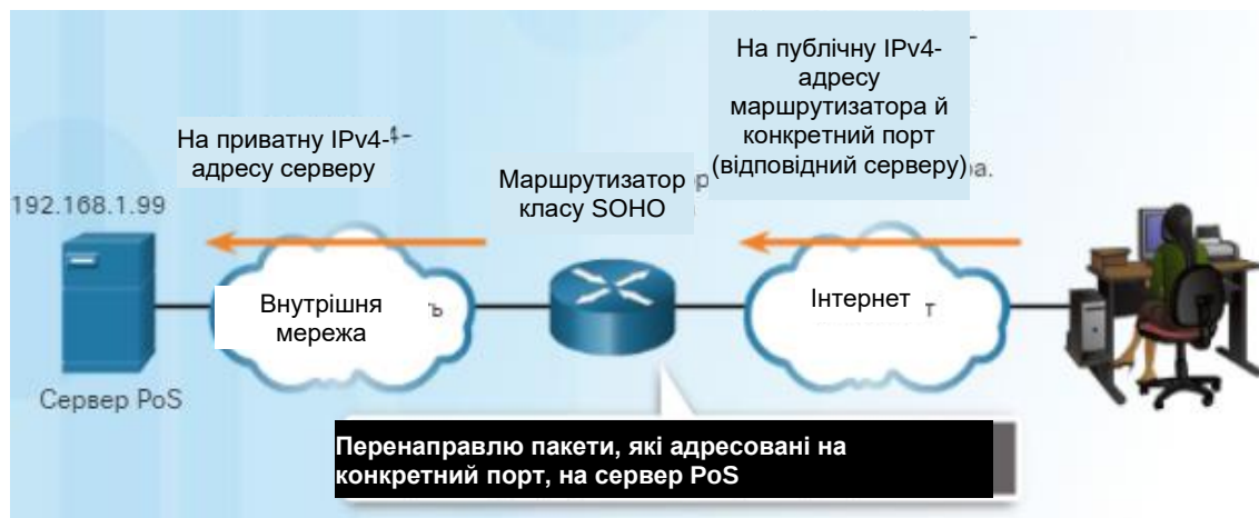
Рисунок 3.47 – Використання перенаправлення портів
