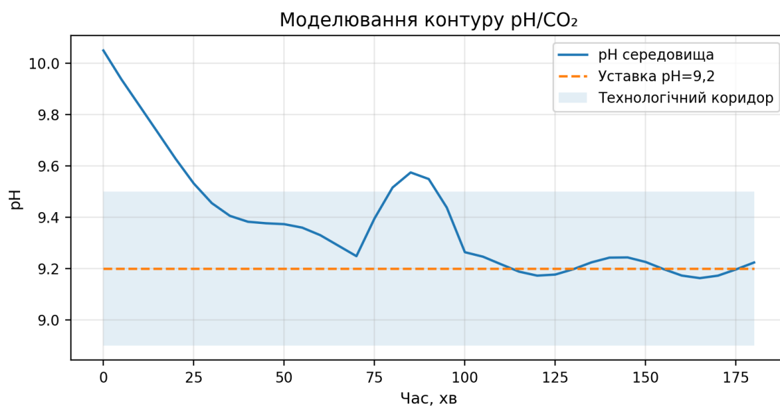
Рисунок 4.4 – Моделювання роботи контуру pH/CO 2
