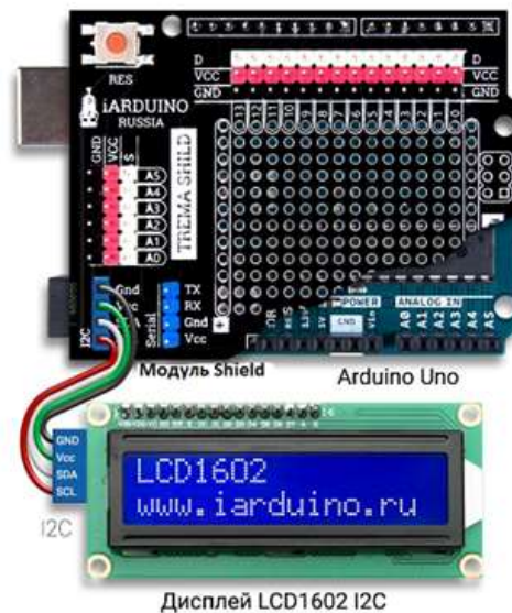
Рисунок 5.2 — Схема підключення дисплею до плати Shield
