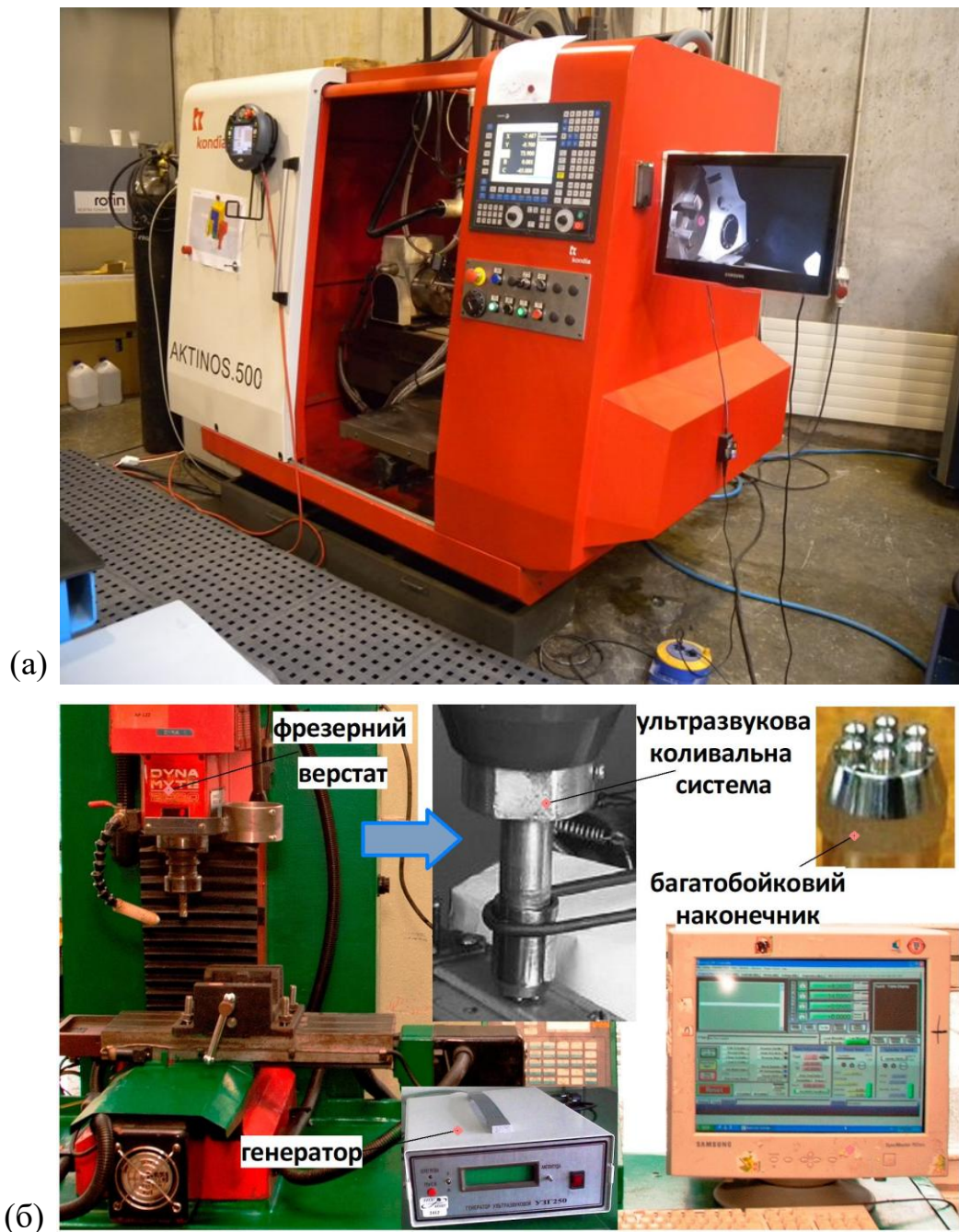
Рисунок 19 – Загальний вигляд обладнання для лазерного термооброблення (а) та для ультразвукового ударного оброблення (б)
