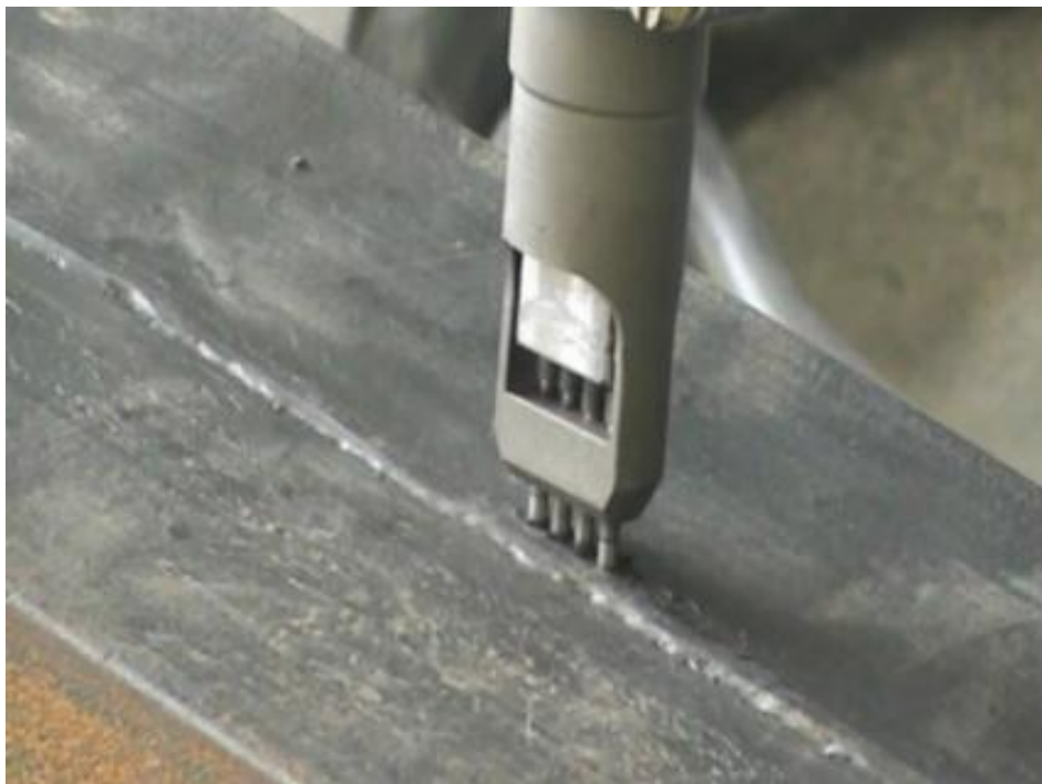
Рисунок 2 - Ультразвукове ударне оброблення зварного шва [4]
