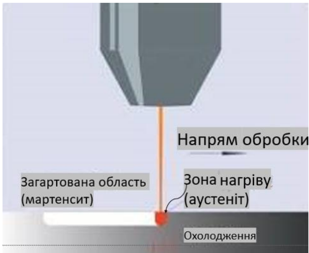
Рисунок 6 – Лазерне гартування (термообробка) [7]
