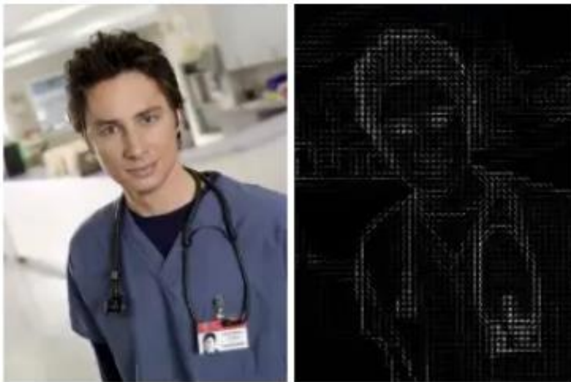
Рисунок 3.5. Зразок вихідного зображення та його гістограма градієнтів
