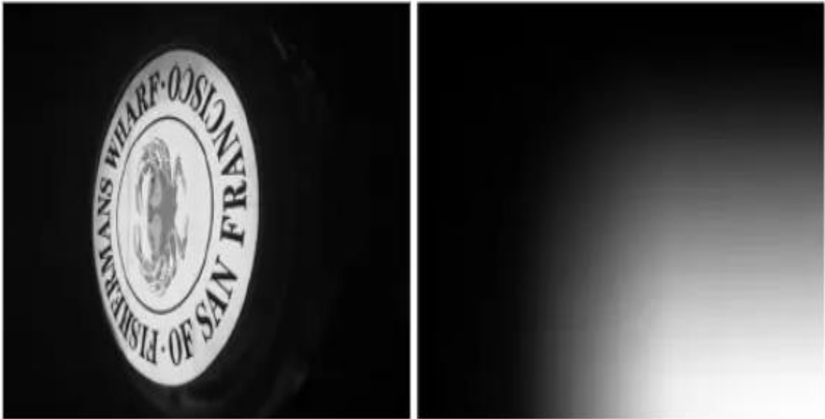
Рисунок 3.1. Приклад обчислення інтегрального зображення за допомогою OpenCV функції integral() .
