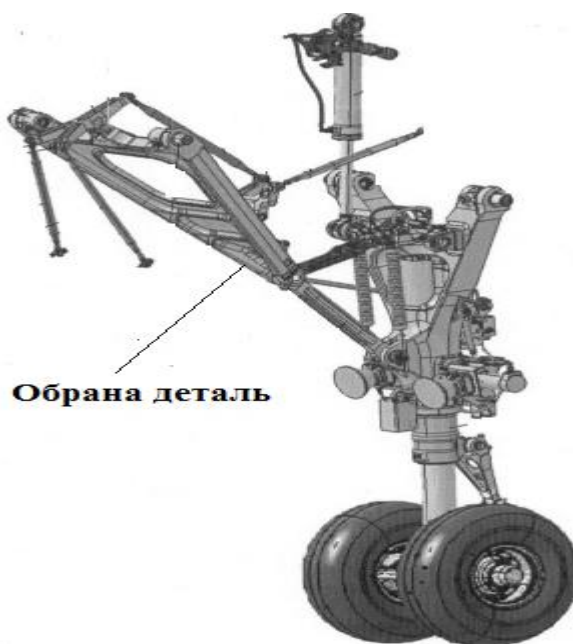
Рис 1.2 – Положення обраної деталі в передній стійці шасі.
