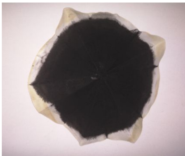
Рис. 2.2 – Паперовий фільтр після фільтрування каталізатору
