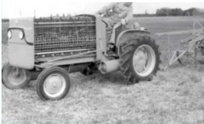
Рис. 1.2 - Трактор Allis Chalmers на паливних елементах, 1959 р
