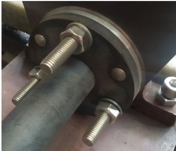
Рисунок 2.21 - Кріплення заготовки з сторони підшипникової опори
