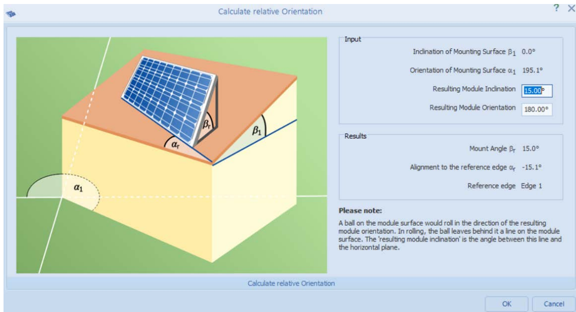
Рис. 7.18. Приклад автоматичного розрахунку оптимальної орієнтації панелей
