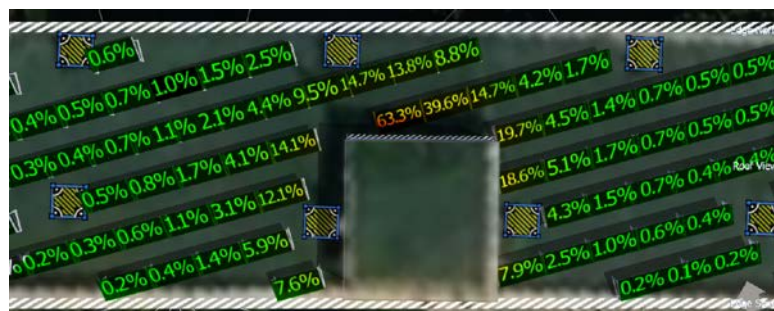
Рис. 7.22. Розрахунок частоти затінення панелей від виступаючих елементів
