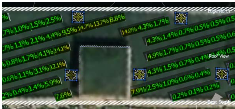
Рис. 7.23. Розрахунок частоти затінення панелей від виступаючих елементів після вилучення найбільш затінених панелей
