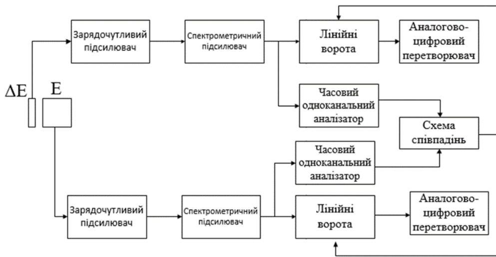
Рис. 2.5 – Узагальнена спрощена блок-схема реалізації \Delta E - E -методу
