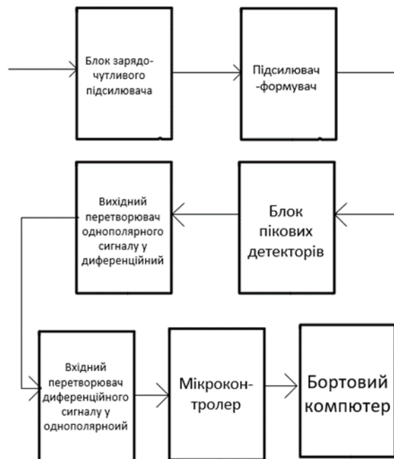
Рис. 2.12 – Структура апаратної реалізації алгоритму для одного спектрометричного каналу
