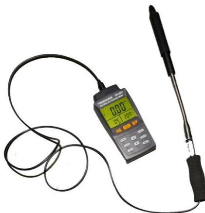
Рисунок 2.22. Термоанемометр Tenmars TM-4001:
