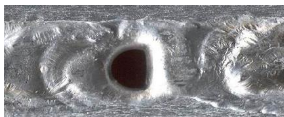
Рисунок 4.10 – Зовнішній вигляд лицьової (а) та зворотної (б) частин зварного з'єднання зі сплаву АМгб, отриманого при застосуванні канавки 10 мм × 1 мм
