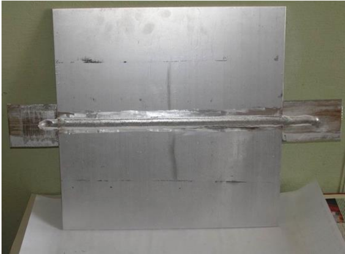
Рисунок 4.13 – Зовнішній вигляд лицьової частини зварного шва стикового з'єднання сплаву 1570, отриманого в нижньому положенні при ПДЗ
