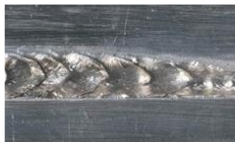
Рисунок 4.9 – Зовнішній вигляд лицьової (а) та зворотної (б) сторін шва, сформованого при ПДЗ з використанням підкладки з канавкою 4 мм × 1 мм
