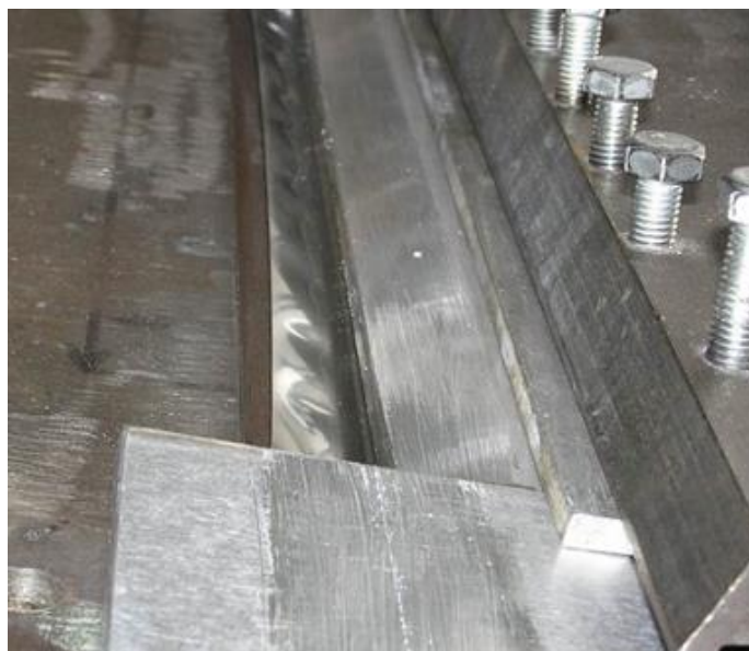
Рисунок 4.12 – Схема складання стику з розміщенням фольги у формувальній канавці
