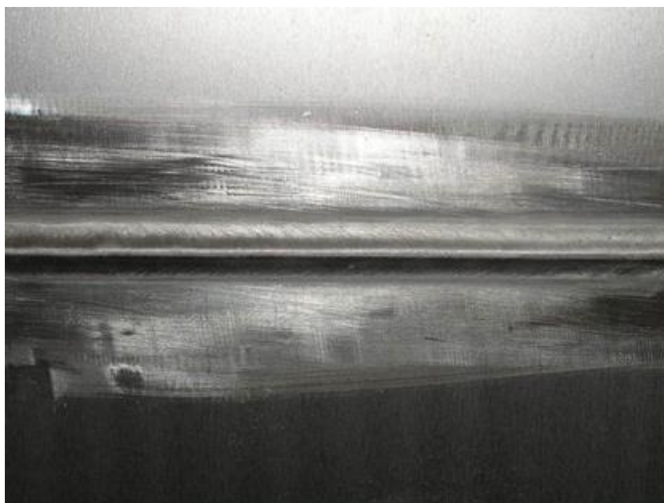
Рисунок 4.15 – Зовнішній вигляд кореневої частини шва після вилучення фольги з нержавіючої сталі
