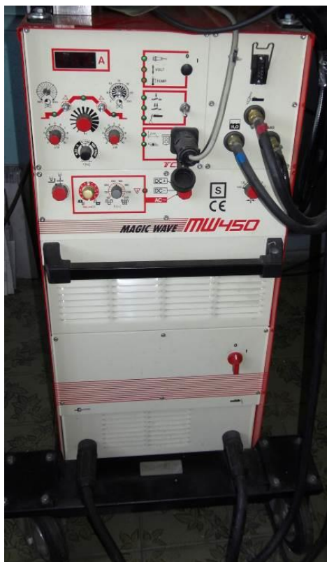
Рисунок 2.1 – Модифіковане джерело живлення зварювального електричного струму MW 450 призначене для аргонодугового зварювання на різнополярному асиметричному струмі
