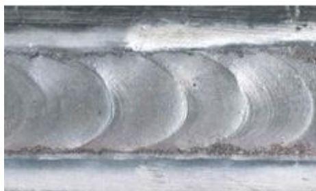
Рисунок 4.9 – Зовнішній вигляд лицьової (а) та зворотної (б) сторін шва, сформованого при ПДЗ з використанням підкладки з канавкою 4 мм × 1 мм
