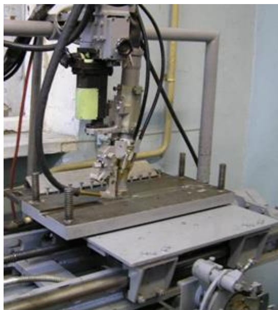
Рисунок 2.6 – Установка для плазмово-дугового зварювання, налаштована для виконання горизонтального зварювального шва на горизонтальній поверхні
