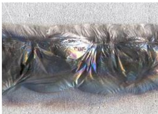
Рисунок 4.4 – Зварний шов виконаний плазмово-дуговим зварюванням на постійному струмі прямої полярності пластини зі сплаву АМгб
