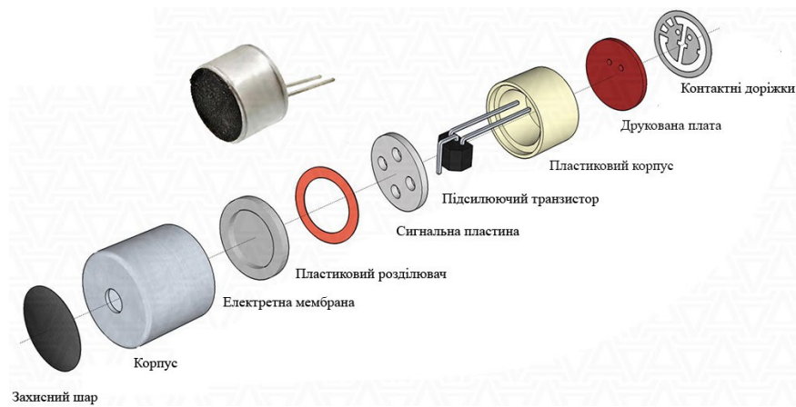
Рисунок 4.2 Будова електретного мікрофону
