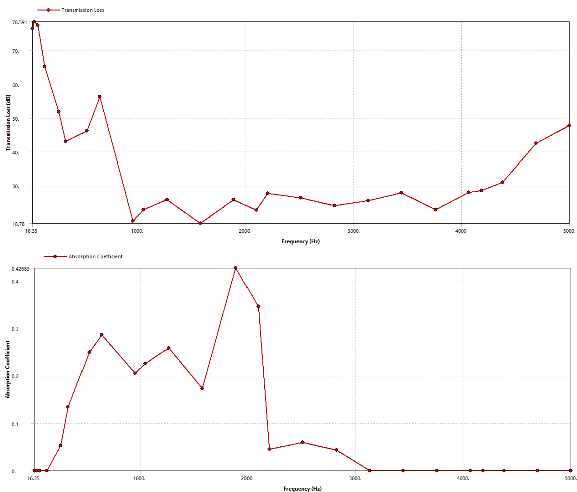
Рисунок 3.10 – Графічні залежності коефіцієнтів TL (а) та AC (б) для приміщення оточення при h = 12 мм та v = 0,25 (джерело шуму розташовано в правій частині)
