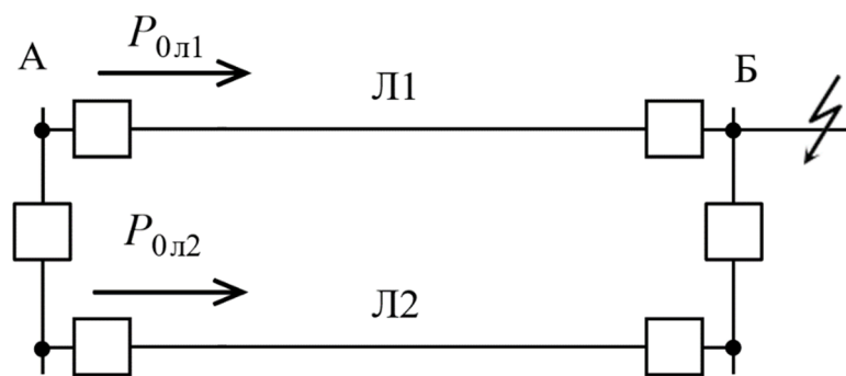
Рисунок 2.7 – Напрямок струмів КЗ при зовнішньому КЗ
