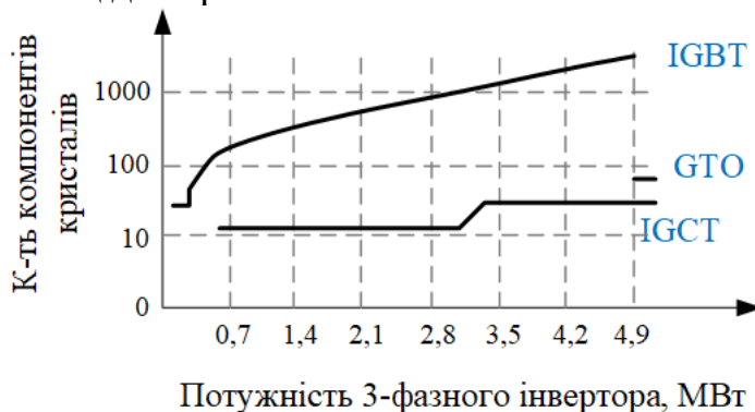
Рис.14.19. порівняння кількості силових компонентів різних типів силових ключів інверторів
