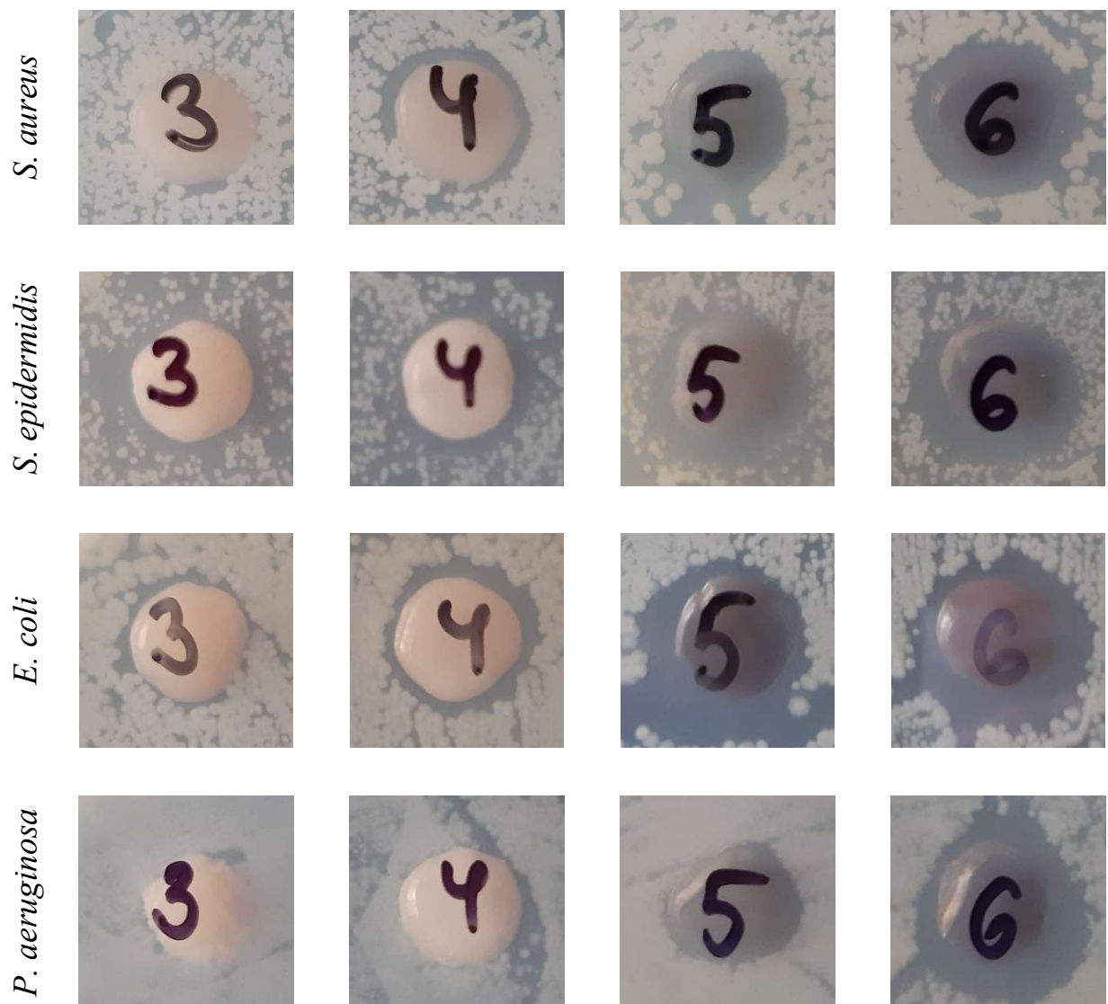
Рисунок 3.19. Бактерицидна дія гідрогелів ПВС-ГК з концентрацією наночастинок \text{Ag}_2\text{O} :
