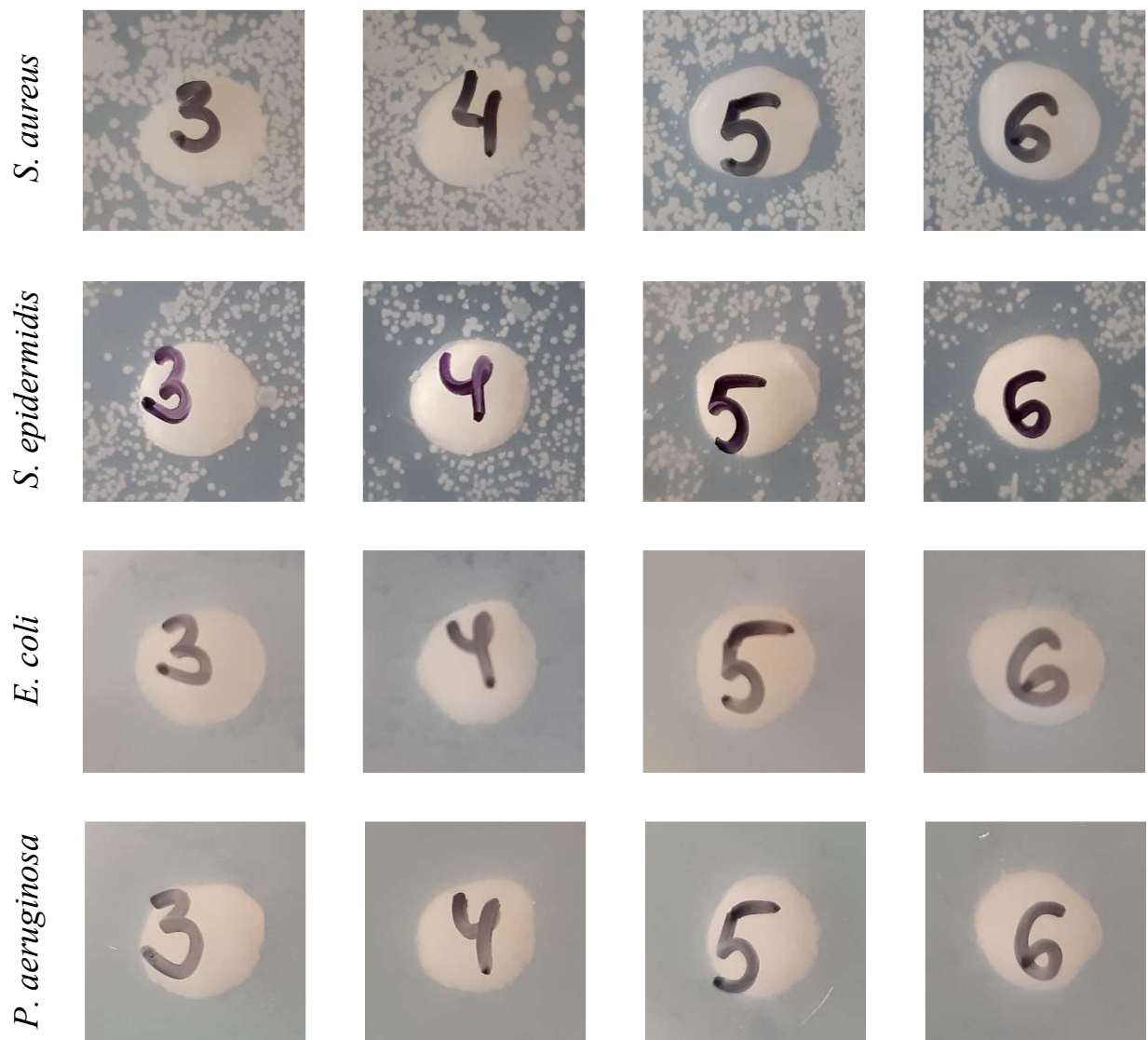
Рисунок 3.18. Бактерицидна дія гідрогелів ПВС-ГК з концентрацією наночастинок ZnO: 0,05мас.% (3), 0,1мас.% (4), 0,5мас.% (5), 1мас.% (6).
