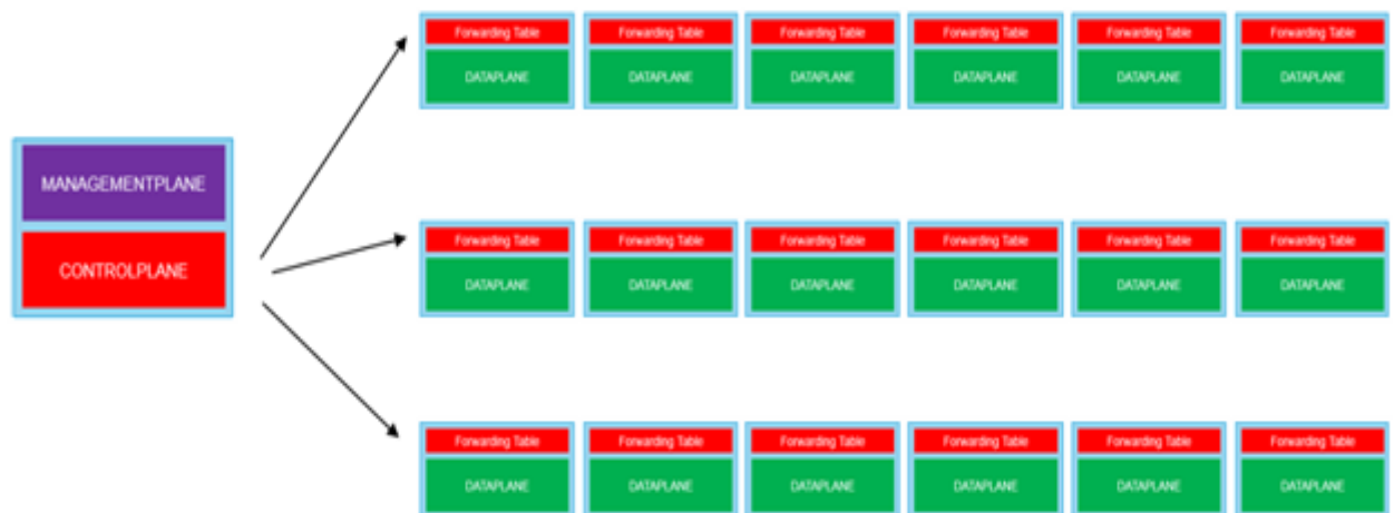
Рисунок 10 – Логічна модель мережевих пристроїв SDN
