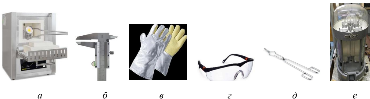
Рис. 1.1. Прилади і матеріали для виконання лабораторної роботи: а – муфельна піч; б – штангенциркуль; в – рукавички; г – захисні окуляри; д – пінцет; е – електронні аналітичні ваги
