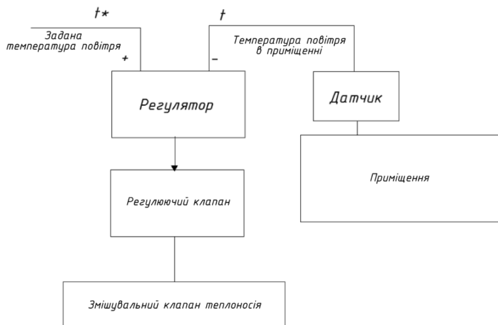
Рисунок 2.8 – Схема функціональна САР температури повітря в приміщенні
