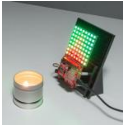
Рис.2.3 – Формування тепловізійної карти датчиком AMG8833
