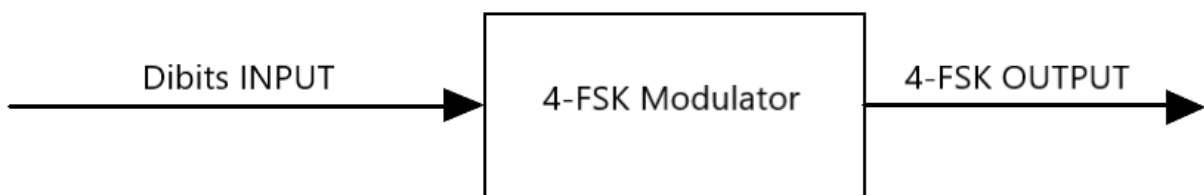
Рисунок 1.6 - схема модулятора 4-FSK
