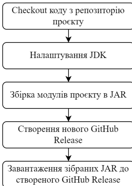
Рисунок 3.25 – Спрощений алгоритм роботи GitHub Actions Workflow системи
