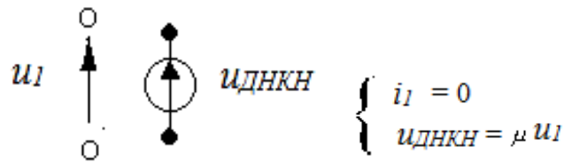
Рисунок 1.19 – Джерело напруги, кероване напругою
