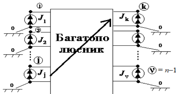
Рисунок 4.6 – Схема із незалежними джерелами струму
