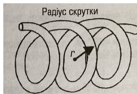
Рис.4.2.11 Визначення радіуса скрутки ОВ
