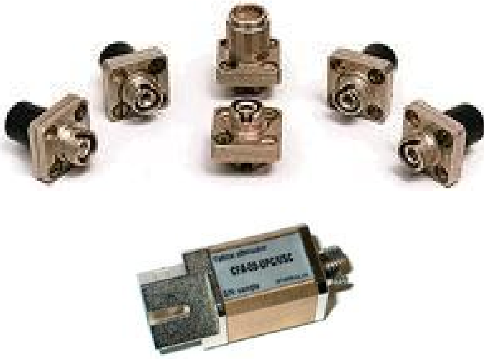
Рис.2.4.3 Оптичний атенюатор у вигляді розетки
