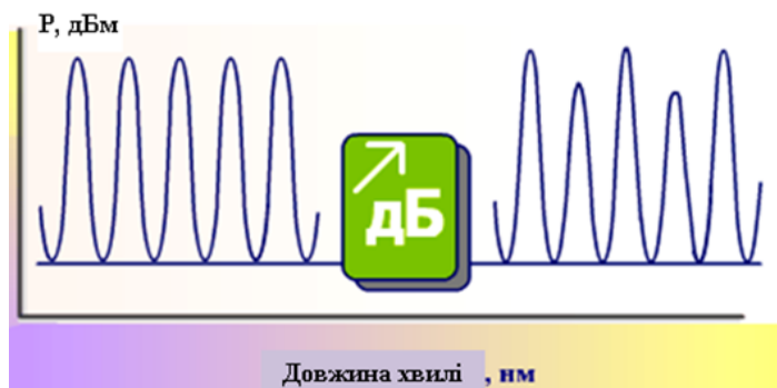
Рис.2.4.5 Вибіркове зменшення потужності на вході оптичного підсилювача EDFA для вирівнювання спектру
