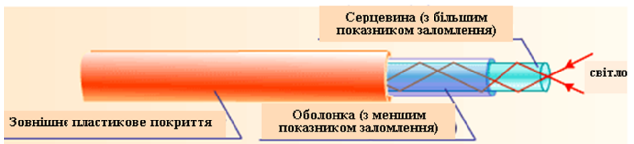
Рис.1.1.1 Структура оптичного волокна
