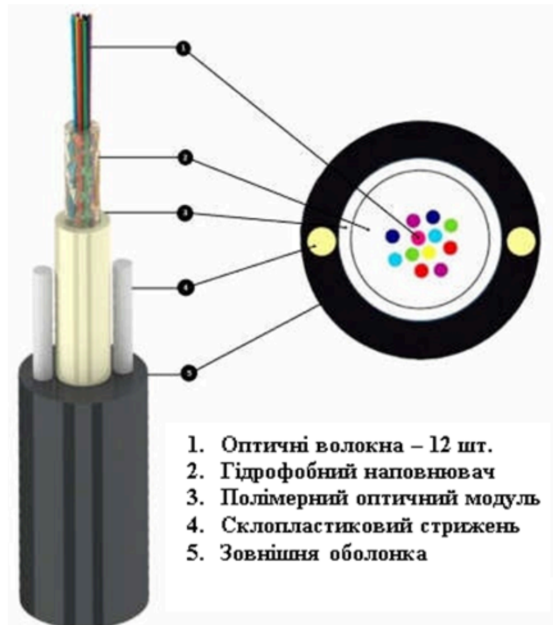
Рис.1.4.2 Конструкція ОК зі склопластиковими стрижнями по периферії [1]
