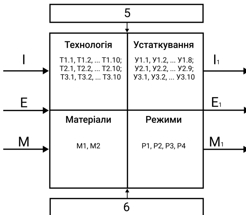
Рисунок 2.24 – Система «чорна скринька технологічного процесу»: I, I 1 — інформація, що вводиться (I) та виводиться (I 1 ) системою, метод та вигляд її подання; E, E 1 — енергія, яка необхідна для здійснення процесу (E) та втрачена (E 1 ); M, M 1 — матеріали до переробки (M) та після (M 1 ) здійснення технологічного процесу; T1.1...Tn — варіанти технологічного процесу; Y1.1...Yn — варіанти використання устаткування (обладнання); M1.1...Mn — витратні поліграфічні матеріали; P1.1...Pn — технологічні режими; 5 — фактори зовнішнього впливу на систему; 6 — нормативні умови роботи системи (ДСТУ, ГСТУ, інші нормативні документи)
